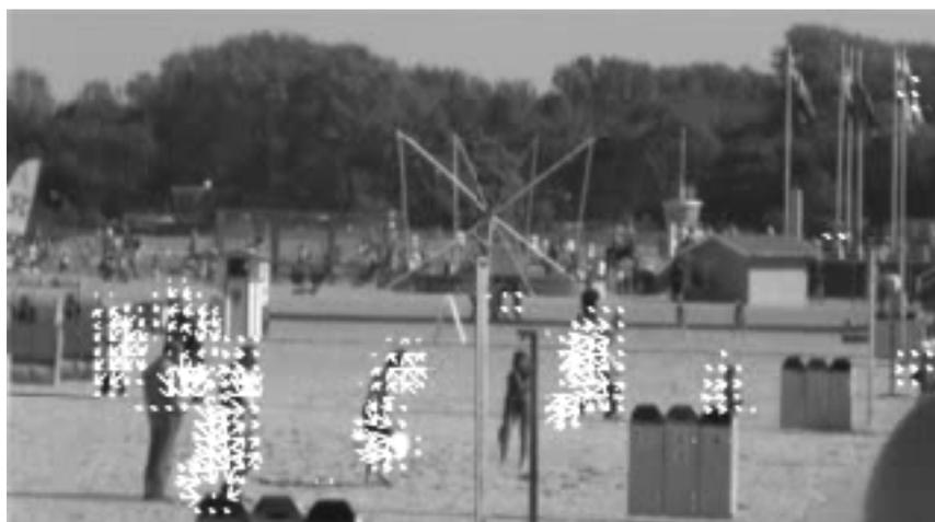
Abbildung 5: Ein Frame eines mit dem MST-Algorithmus analysierten Films. Jeder Pfeil zeigt die Richtung und Stärke der Bewegung in diesem Pixel an.
