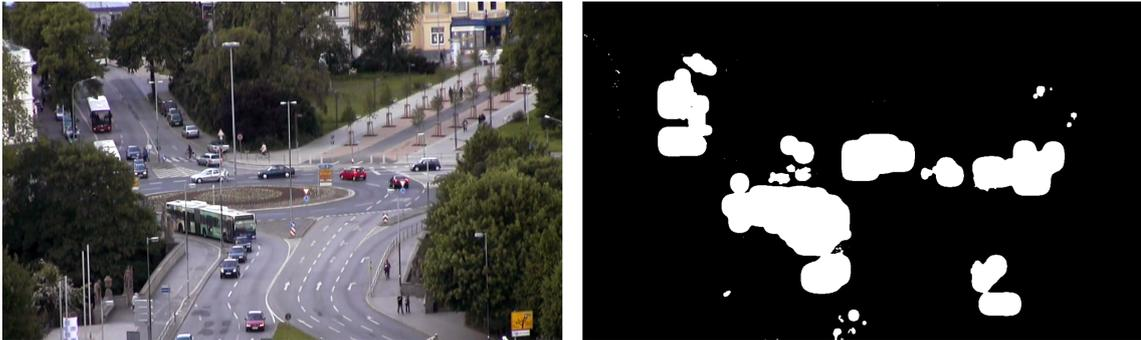
Abbildung 6: Die linke Seite zeigt ein Frame eines Originalfilmes, die rechte Seite den zugehörigen Frame des velocity movies. Hierbei sind in weiß die Pixel mit und in schwarz die Pixel ohne geschätzte Bewegung dargestellt.
